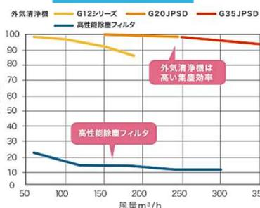
※定格風量時・光散乱式気中粒子計数器にて、0.3μm以上の粒子の除去率を外気清浄ユニットにて測定。
